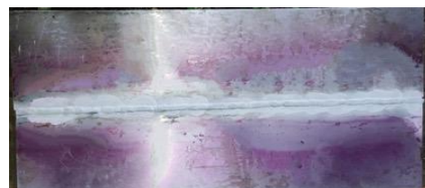
Gambar 6 Hasil dye penetrant las arus 130 A
