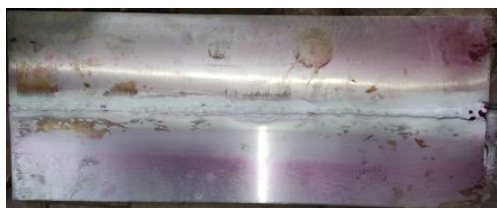
Gambar 5 Hasil dye penetrant las arus 100 A
