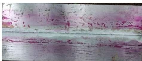
Gambar 7 Hasil dye penetrant las arus 160 A
