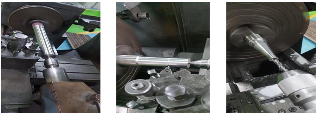
Gambar 4. Beberapa proses bubut *spindle test bar*
