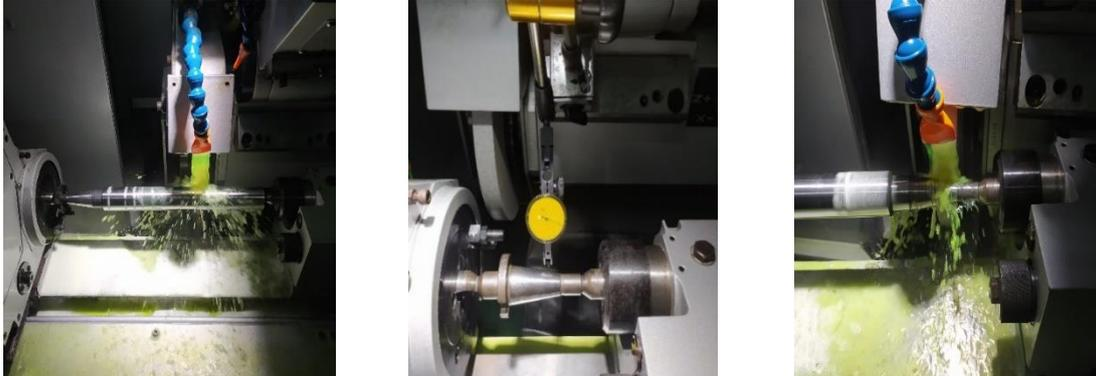
Gambar 5. Proses Penggerindaan *Spindle Test Bar*
